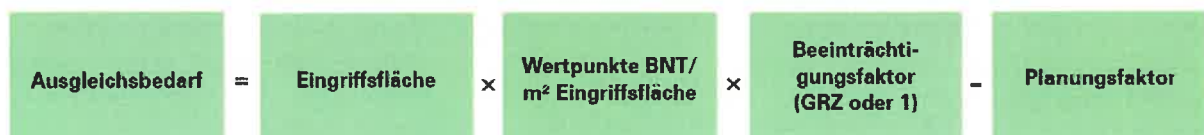
Abbildung 1: Matrix zur Ermittlung des Ausgleichbedarfs des Schutzguts Arten und Lebensräume. (Quelle: Bayerisches Staatsministerium für Wohnen, Bau und Verkehr, 2021, S.19)
