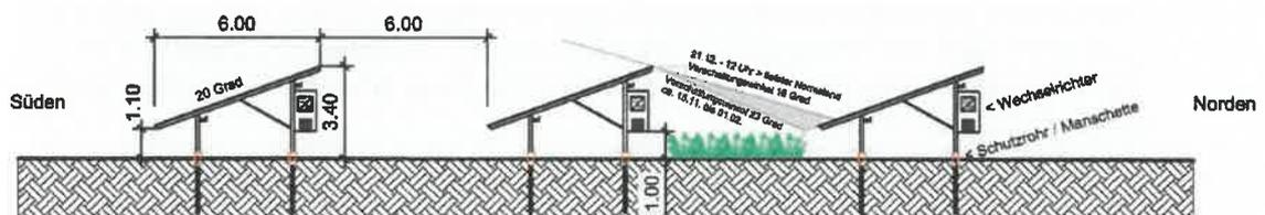
Abbildung 8 - Systemschema möglicher Aufbau
