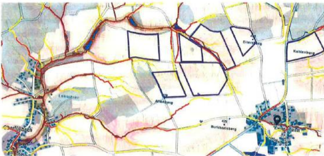
Neigungskarte mit Oberflächenabfluss kombiniert mit Sturzflutkarte Umweltatlas Bayern; Hinweise aus der Karte müssen vor Ort mit lokalem Wissen überprüft und ergänzt werden.
