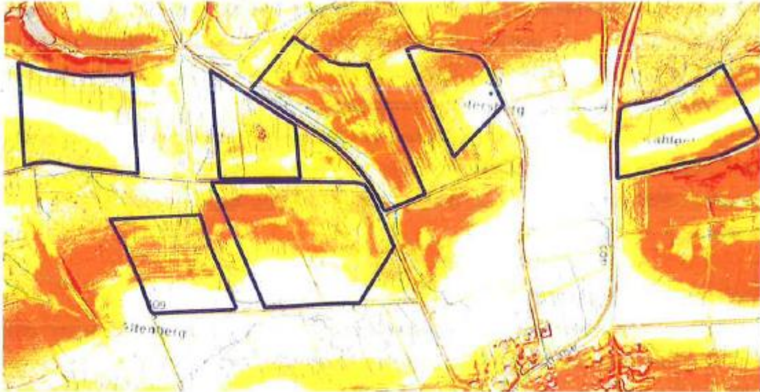
Neigungskarte mit Oberflächenabfluss bei Starkregen (modelliert mit DGM1 2022)
